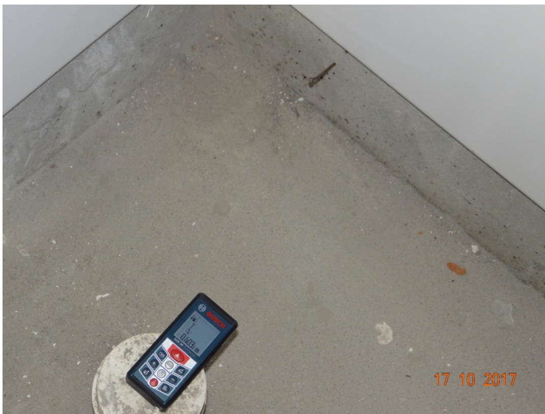
Foto 3 – Medição da distância entre o eixo do vaso sanitário e a parede do banheiro PNE próximo ao pátio coberto.
